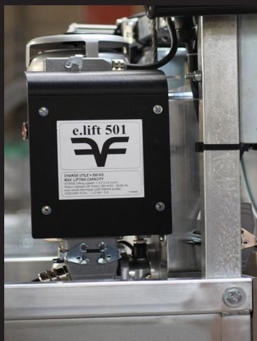
équipé du treuil électrique e.lift 501
